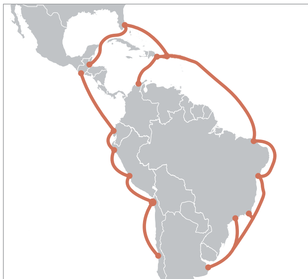
Рис. 1.10. Система SAM-1 связывает маршрутизаторы в 16 городах из 11 разных стран, используя более 15 тысяч миль подводных кабелей
