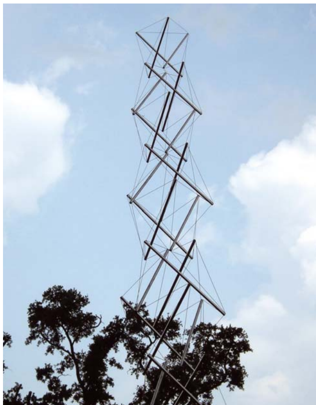
Рис. 0.4. Используя натянутые тросы и металлические распорки, можно создать самонесущие конструкции. Целостность этой конструкции определяется взаимодействием элементов сжатия и натяжения. Как отмечает Снельсон, если в простой структуре разрушение одного элемента может привести к разрушению всей структуры, в более сложных конструкциях подобный вызов в одной из ее областей приведет к менее катастрофическим последствиям (подробнее об этом — на его веб-сайте http://kennethnelson.net/faq ). Мы снова вернемся к этому, когда будем рассматривать тело и то, как оно может адаптироваться к дисфункции в какой-либо из его областей
