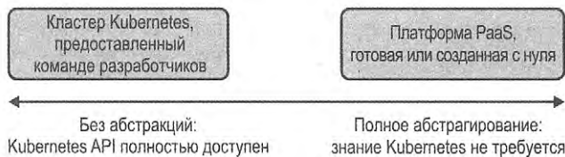
Рис. 1.9. Противоположные концы спектра: предоставление каждой команде отдельного кластера Kubernetes или полная инкапсуляция Kubernetes в виде платформы как сервиса (англ. Platform as a Service или PaaS)
