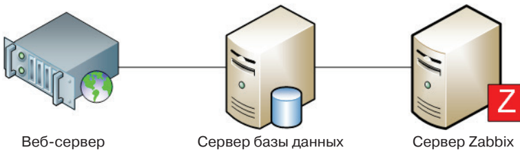
Рис. 1.1 ❖ Трехуровневая архитектура Zabbix
