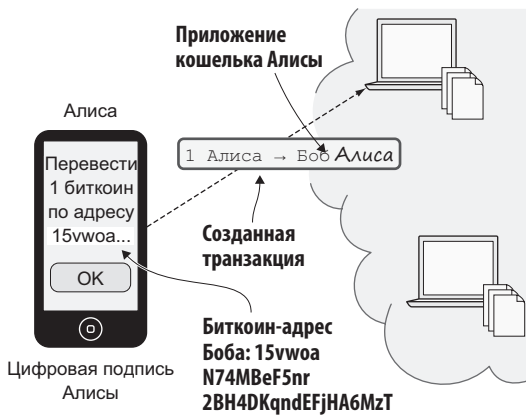
Рис. 1.3. Алиса создает транзакцию, подписывает ее и посылает одному или нескольким узлам в сети Биткоин
